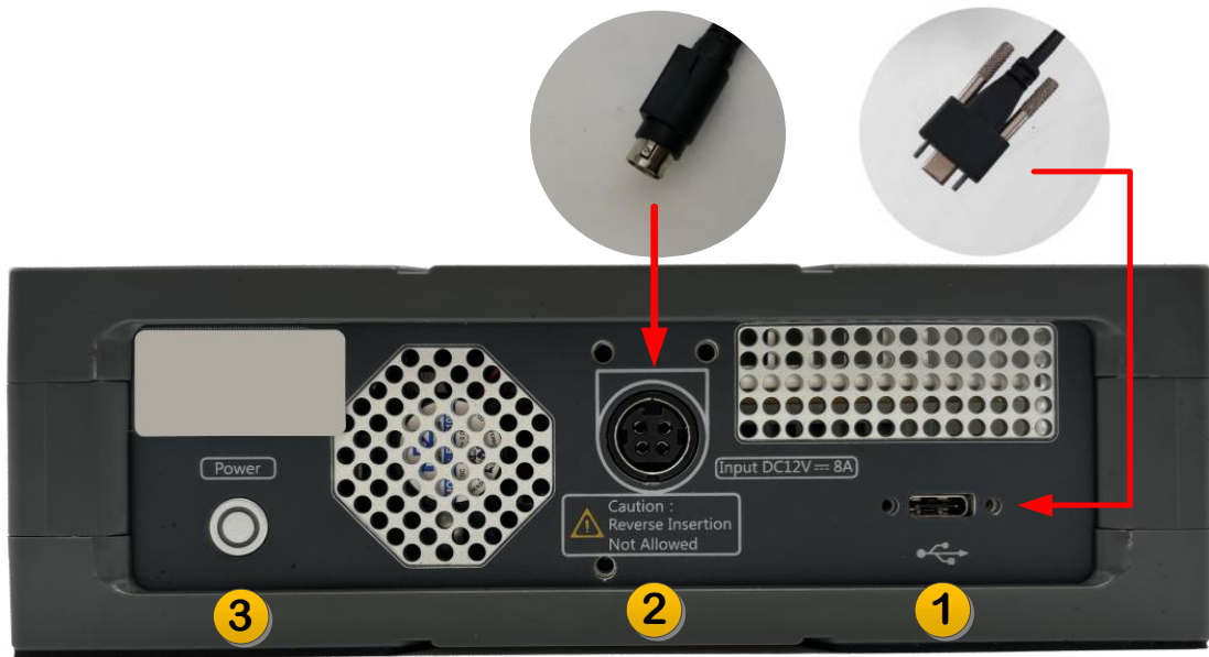
图10. 连接电源适配器与 USB 电缆
